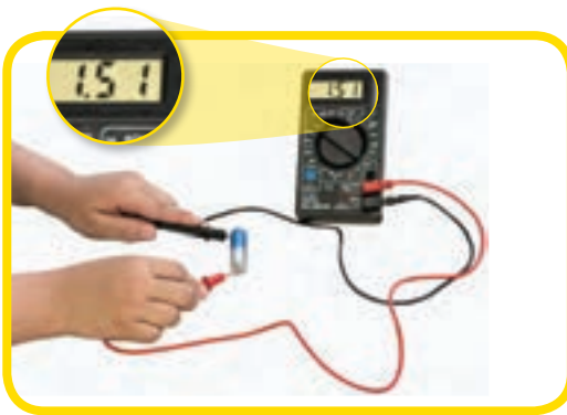
شکل ۶- اندازه‌گیری اختلاف پتانسیل دو سر باتری
