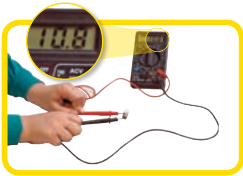
شکل ۸- اندازه‌گیری مقاومت لامپ خاموش با اهم سنج
